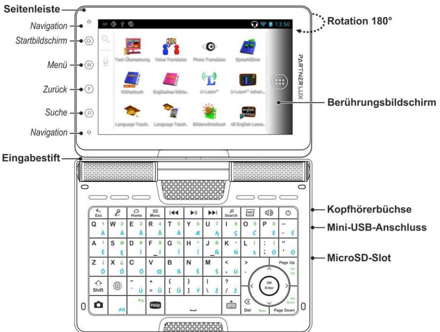
Dank dem Drehbildschirm kann sich das Gerät leicht in ein handliches Tablet verwandeln. Dazu drehen Sie einfach den Bildschirm im Uhrzeigersinn um 180 Grad. Um den Bildschirm in die Ausgangsposition zu bringen, drehen Sie ihn im Gegenuhrzeigersinn um 180 Grad.
